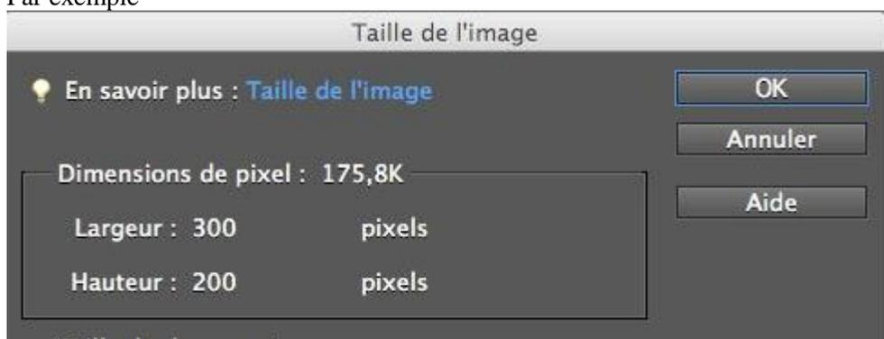
La taille est :  $300*200*24 \text{ bits/pixels} = 1440000 \text{ bits} = 1440000/8=180000 \text{ octets}=180000/1024=175.8 \text{ ko}$
