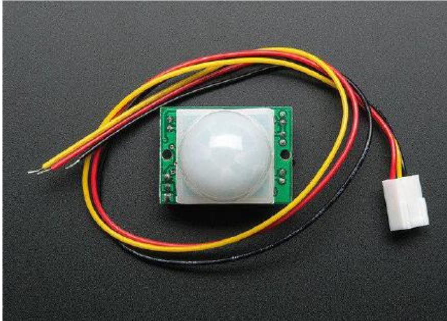
Le capteur PIR est un capteur de mouvements.
