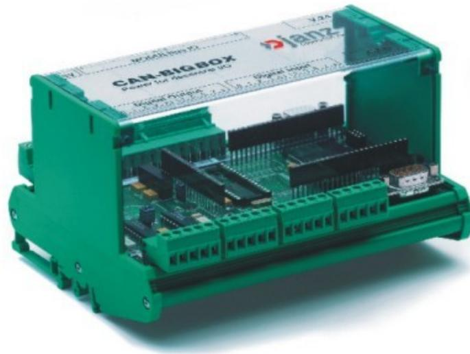
Le CAN bigbox de janzz computer comporte 8 entrées et 8 sorties isolées ainsi qu' une socket MODULbus. Cette socket apporte à l'ensemble de la structure diverses possibilités d'application en fonction du module qui lui est raccordé. Par mis eux, nous pourrons trouver un module permettant de contrôler un moteur local, un module d'acquisition ou encore un module permettant d'obtenir 4 ports rs232 supplémentaire.
