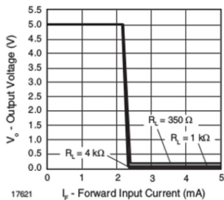
Le courant de 4,5 mA est au-dessus du seuil de basculement de la led (2,3 mA environ).
