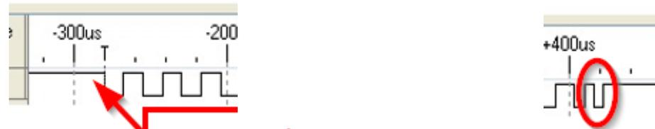
Début de trame à  $-285 \mu\text{s}$  **BIT 0** et fin de trame à  $415 \mu\text{s}$ .
