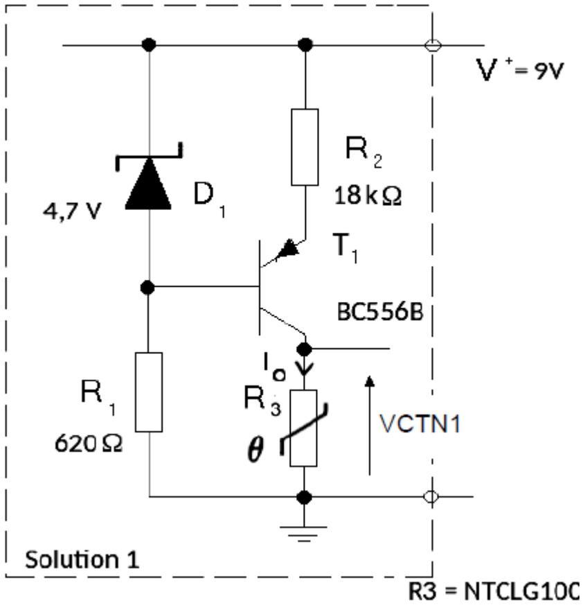
La diode Zéner va imposer une tension de 4.7V et  $V_{EB} = 0.6V$  C'est un générateur de courant constant.
