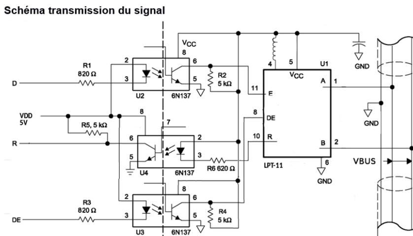
Quand le point D est à '0' la diode conduit, le courant dans la diode est supérieur à 2,3mA donc  $V_o = 0$  V.
