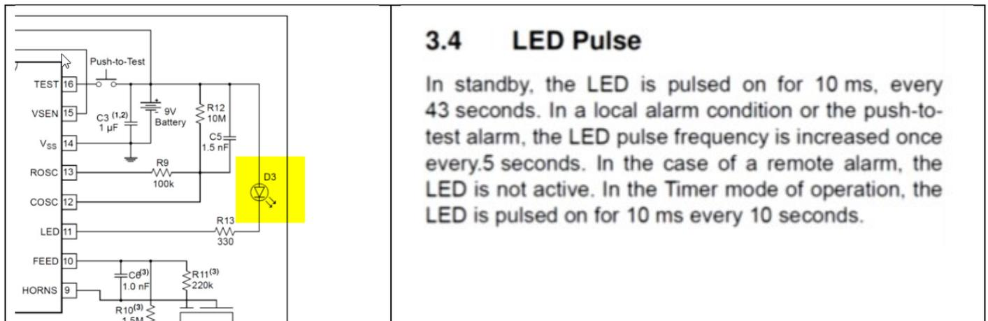
La led D3 signale une détection de fumée par une augmentation de la fréquence des flashes une fois toutes les 5s.
